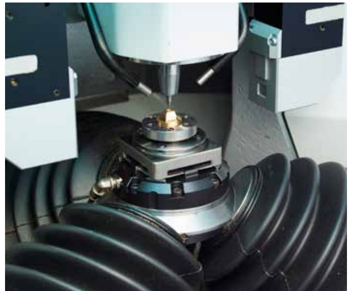
Lähikuva lineaariakseleista, Kappale kiinni 3-jalkaisella "hämähäkillä", kara kiinteä, 12 paikkainen kappalepaletti vakiona, 36 työklaun makasiini, 5G kiihtyvyydet, resoluutio < 0,01 µm (10 nm).
